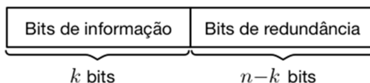
Figura 14 - Exemplo de estrutura de um código sistemático.
