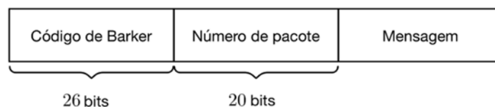
Figura 47 - Estrutura do pacote transmitido com o seu número associado.
